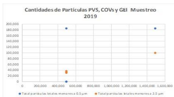
Figura 3 Bis. Gráfico de la cantidad de partículas sedimentarias detectadas por sensores del AccuSizer A7000 equivalentes a un muestreo 1,490,667/Q=15ml, de las cuales 184,807 menores 0.5 \mu\text{m} equivalentes al 12.39 % y 100,008 a \geq 2.5 \mu\text{m} = al 6.70%.
