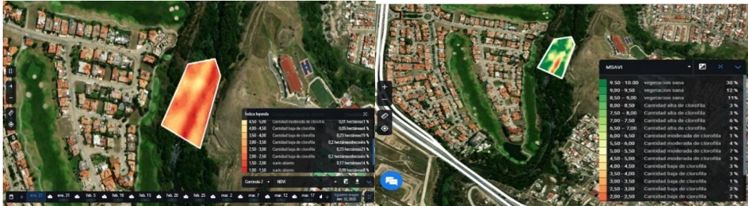
Figura 11. (Izq.) Imagen satelital multispectral del satélite Sentinel 2 de la ESA-UE de enero 2023, (Der.) Imagen de noviembre 2023. Determinación de valores del índice RCEI. En tonos rojos oscuros sobre polígono caudal de las corrientes del río Atoyac, en verde ecosistema con densidades de vegetación forestal, pastos y suelos desnudos.
