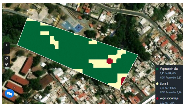
Figura 17. Imagen de satélite multispectral del Sentinel 2 zonificada con análisis de superficies vs. Densidades de vegetación
