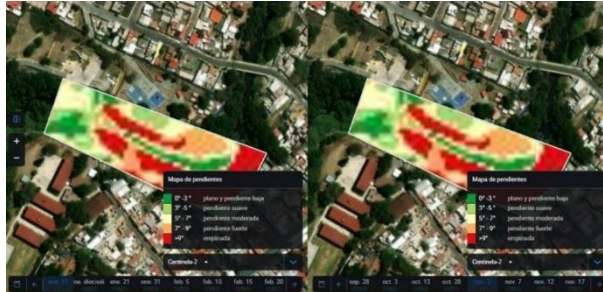
Figura 19: Imagen satelital multiespectral del satélite Sentinel 2 de la ESA-UE de la zona urbana y periurbana (Izq.) Enero del 2023, (Der.) Noviembre del 2023. Señala Pendiente en grados con la ubicación de los puntos con mayor inclinación en color rojo rumbo ESE.
